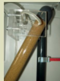
Centralina automatica preparazione flocculante e sistema di rilevamento ad infrarossi.
