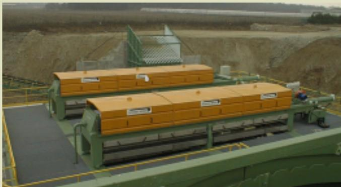
Filtropressa a piastre TECNOIDEA modello 1300/75/30 per la disidratazione dei fanghi.
