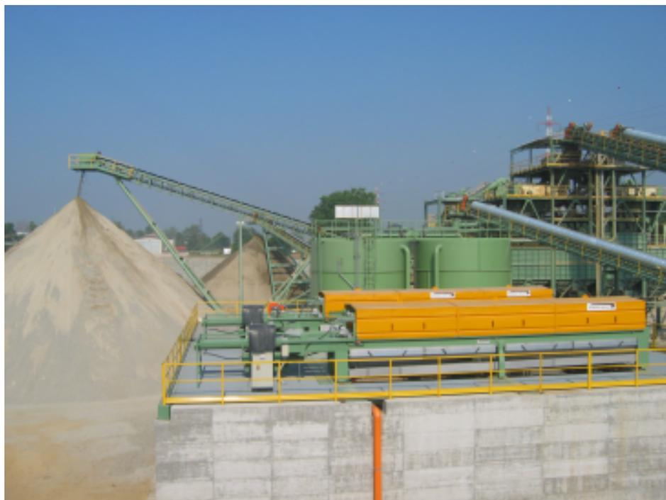
esempio l'ostruzione dei canali di scarico da parte di qualche corpo estraneo o lo slittamento dei nastri trasportatori. Per cercare di ridurre al massimo i danni provocati da tali inconvenienti sono stati nel primo caso installati sensori volumetrici mentre per il secondo ogni nastro trasportatore è stato munito di un sistema di contagiri elettronico che bloc-
